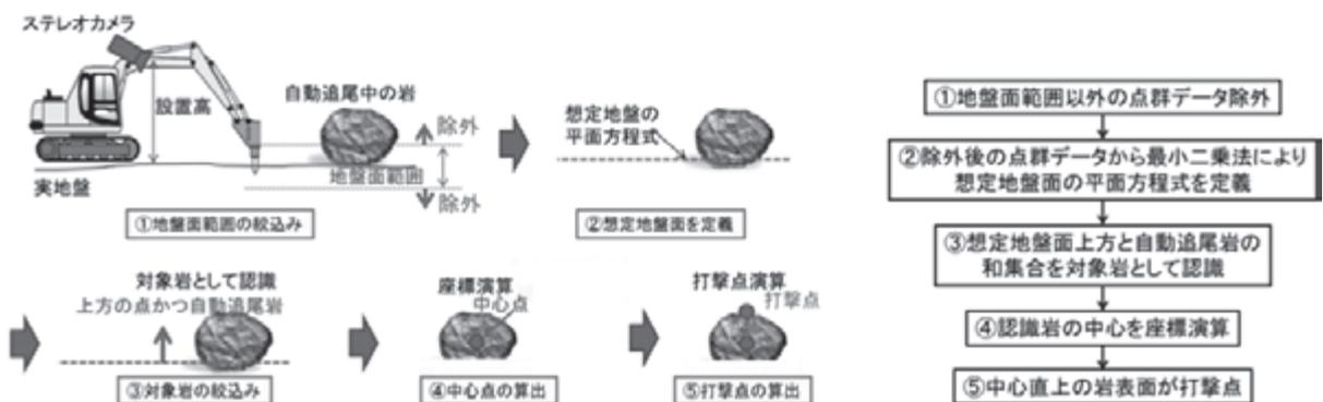
図一九 打撃点算出ステップ (左: イメージ図, 右: フロー図)
