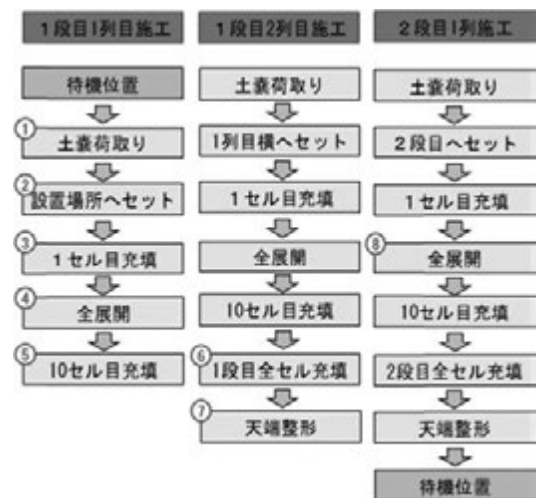
図-3 新型土嚢施工フロー
