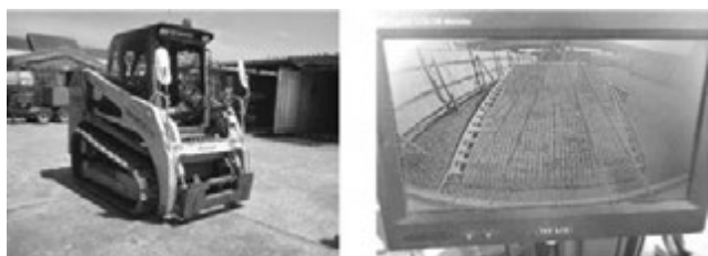
写真—6 安全補機類（バックミラーとバックモニター）
