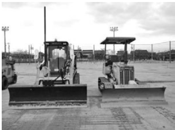
写真—2 4t級ブルドーザとの機体比較
