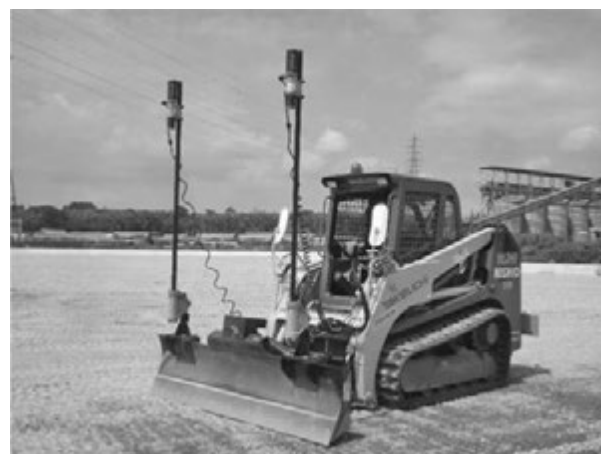
写真—10 チルト動作への対応（デュアルマスト設置状況）
