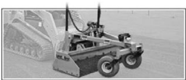
写真—4 自動制御機構を備えたアタッチメント例 (ATI 社 LevelBest LASER GRADING BOX)
