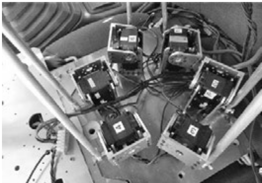
写真一1 胴体部のリンク機構
