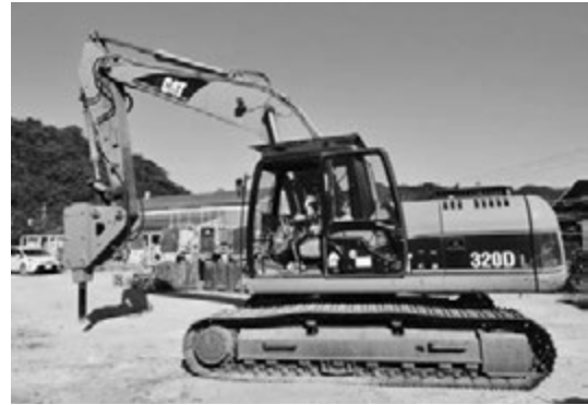
写真-13 破碎作業用のバックホウ
