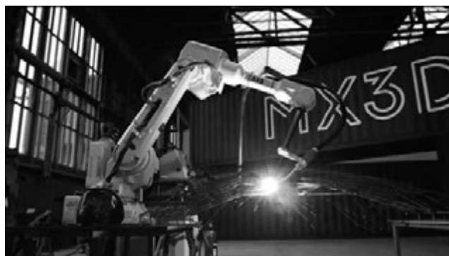
図—16 産業用ロボットのような形をした 3D プリンター (写真：MX3D B.V.)
