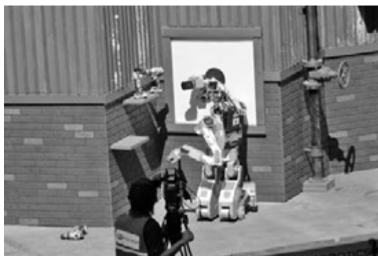
写真一七 正座姿勢で穴開けを行う KAIST「DRC-HUBO」
