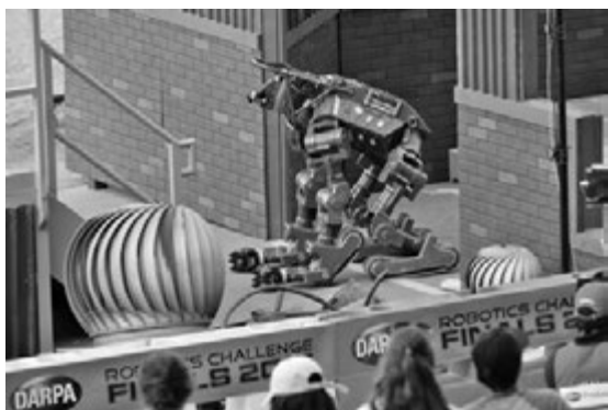
写真—8 四つのクローラーで移動する「CHIMP」
