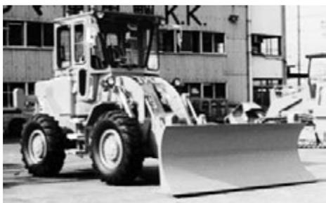
写真 5-13 除雪ドーザ Cat920 キャタピラージャパン<sup>(株)</sup> 昭和45年
