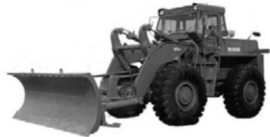
写真 5-10 14t級除雪ドーザ125Ⅲ 東洋運搬機(株)<sup>(注1)</sup> 昭和42年
