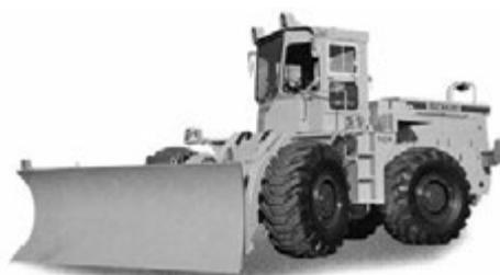
写真 5-25 18t 級除雪専用ドーザ 180S 東洋運搬機株<sup>(注1)</sup> 昭和 53 年
