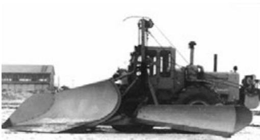
写真 5-4 ホイル式ドーザ WH 型 三菱日本重工業(株)<sup>(注4)</sup> 昭和32年
