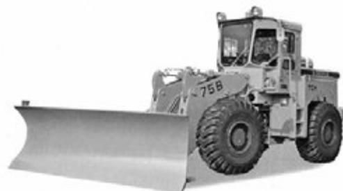
写真 5-22 12t級除雪ドーザ 75B 東洋運搬機株<sup>(注1)</sup> 昭和50年
