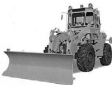
写真 5-24 9t 級除雪ドーザ 55B 東洋運搬機株<sup>(注1)</sup> 昭和 52 年
