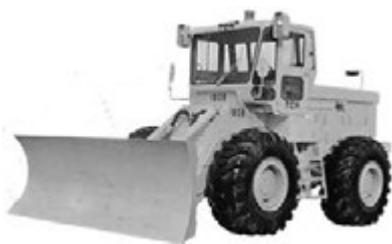
写真 5-19 18t級除雪専用ドーザ 180B
