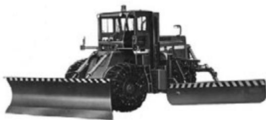
写真 5-12 プラウ付、サイドウイング付ホイールドーザ 180ⅢS 東洋運搬機<sup>(注1)</sup> 昭和44年
