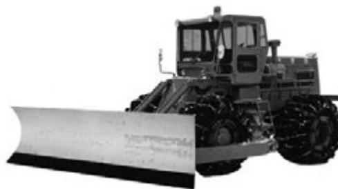
写真 5-14 19t級除雪ドーザ 220 東洋運搬機<sup>(注1)</sup> 昭和45年
