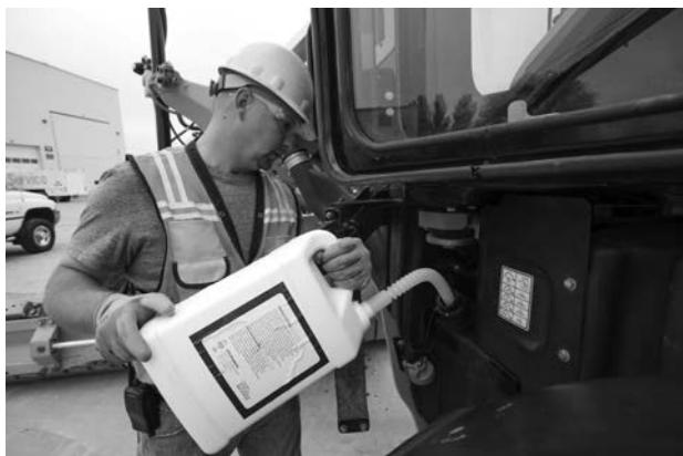
写真一六 地上からの尿素水補給
