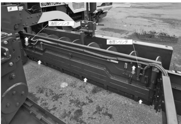
写真一 二 油圧上下式伸縮モールドボード
