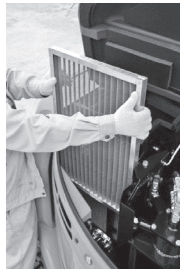
写真-7 新防塵フィルターの脱着
