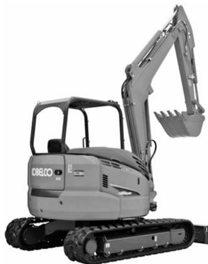
写真-1 5トン機の外観
