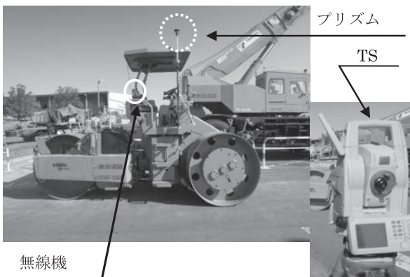
写真—6 TS 転圧管理システム機器構成
