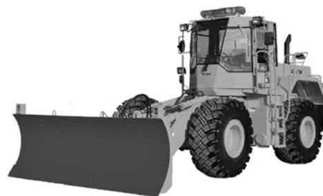
写真 5-35 19t級除雪専用ドーザ E180 東洋運搬機<sup>(注1)</sup> 平成8年
