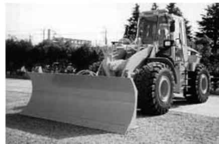
写真 5-41 除雪ドーザ Cat962G キャタピラー・ジャパン(株) 平成 10 年
