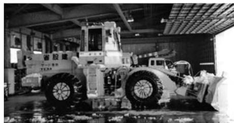
写真 5-33 16t級除雪専用ドーザ 160S 東洋運搬機<sup>(注1)</sup> 平成6年
