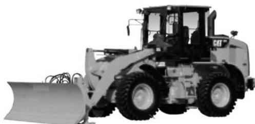
写真 5-51 除雪ドーザ Cat924Hz キャタピラージャパン(株) 平成 18 年
