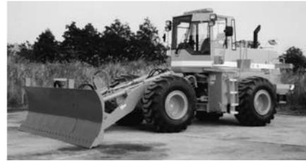
写真 5-39 E180 用折りたたみ式サイドスライドアングリングプラウ
