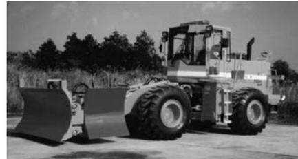
写真 5-40 除雪ドーザ Cat938G キャタピラー・ジャパン(株) 平成 10 年
