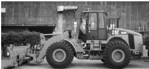
写真 5-50 除雪ドーザ Cat962H キャタピラージャパン(株) 平成 18 年
