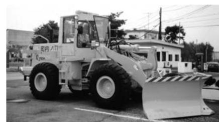
写真 5-42 13t 級除雪ドーザ L26 東洋運搬機(株)<sup>(注1)</sup> 平成 10 年
