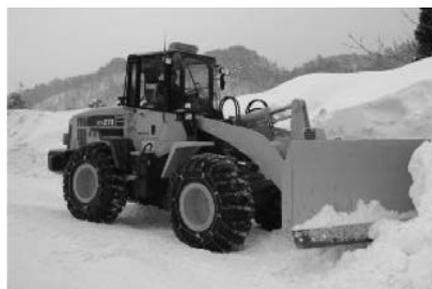
写真 5-46 13 t 級除雪ドーザ WA270-5Y 株小松製作所 平成 15 年
