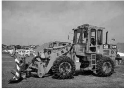
写真 5-36 除雪ドーザ Cat924F II キャタピラー・ジャパン(株) 平成 8 年
