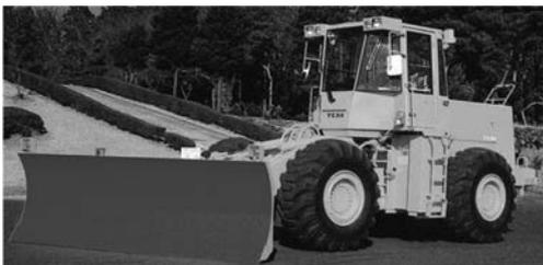
写真 5-31 19t級除雪専用ドーザ 180S-3 東洋運搬機<sup>(注1)</sup> 平成2年
