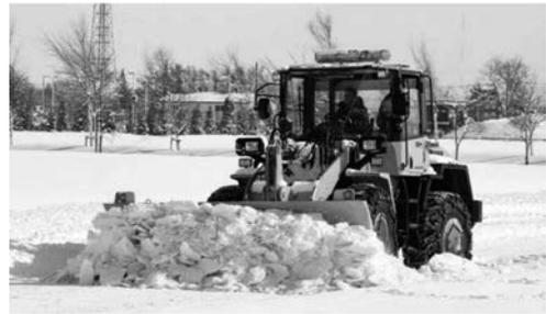
写真 5-52 13t 級除雪ドーザ WA270-6Y (株)小松製作所 平成 19 年
