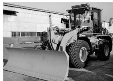
写真 5-54 除雪ドーザ Cat910H キャタピラージャパン(株) 平成 20 年
