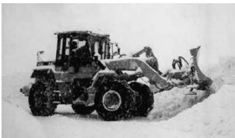
写真 5-32 除雪ドーザ Cat950F II キャタピラージャパン(株) 平成6年
