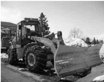
写真 5-49 除雪ドーザ Cat950H キャタピラージャパン(株) 平成 18 年
