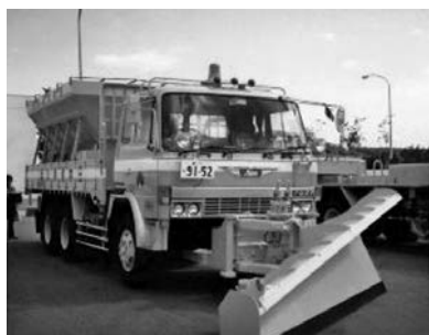
写真 6-11 ベルトコンベア式凍結防止剤散布車 MS-80BI (S) 型 8 m 3 (除雪ブロー付) 範多機械(株) 昭和 57 年 旧日本道路公団
