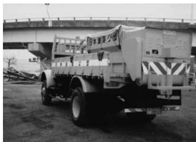
写真 6-16 車載式小型散布機 MS-10MD 旧日本道路公団 昭和 53 年
