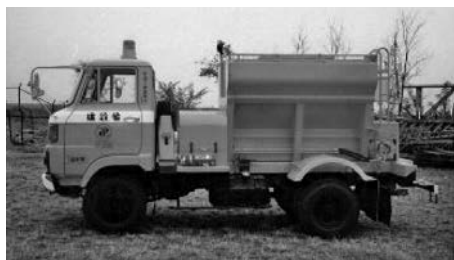
写真 6-13 ベルトコンベア式凍結防止剤散布車 MS-20BIT (F) 2 m 3 旧建設省関東地方建設局 昭和 57 年
