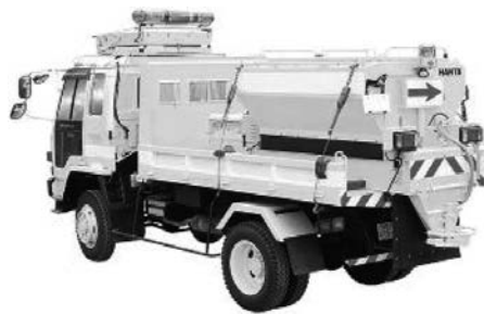
写真 6-14 サブエンジン油圧式小型散布機 MS-MH 範多機械(株) 昭和 56 年
