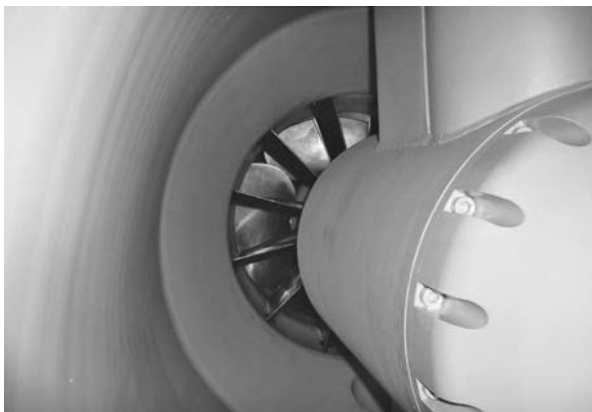
写真—2 水車内部の可変翼
