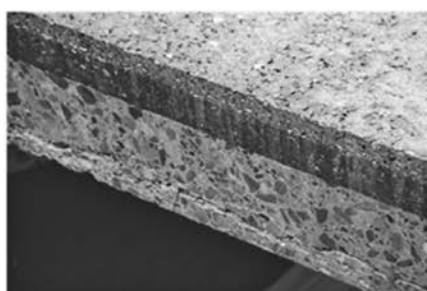
写真ー3 RC床版の切出・損傷状況・輪荷重試験状況
