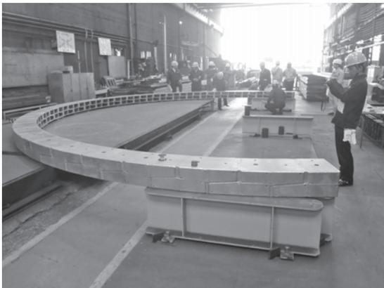
写真一 組立形状試験状況
