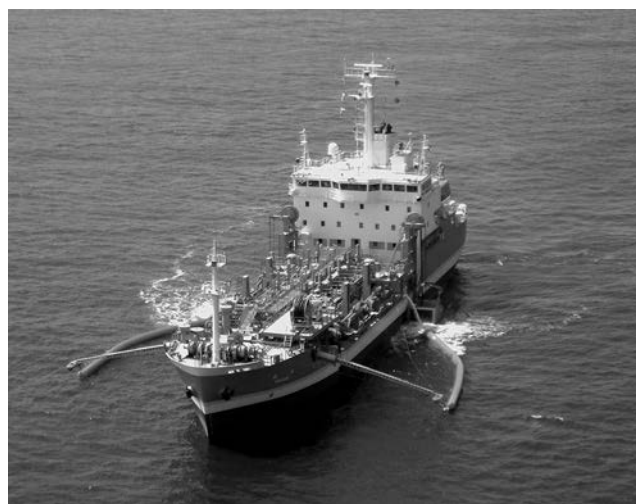
ドラグサクション浚渫兼油回収船「白山」 北陸地方整備局所有
