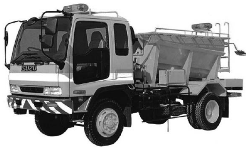
写真 6-33 乾式凍結防止剤散布車 ESD22 東洋運搬機(株) (注1) 平成7年
