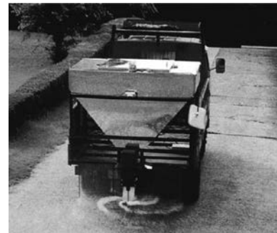
写真 6-31 搭載型散布機 ESD10R 東洋運搬機(株) (注1) 平成 5 年
