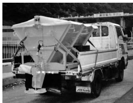
写真 6-23 搭載型散布機 1 m 級 ESD10 東洋運搬機(株) (注1) 昭和63年
