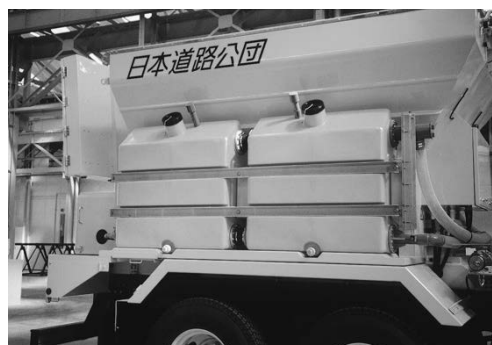
写真 6-28 湿式凍結防止剤散布車 MS-BWTの急速給水対応型ポリエチレン製溶液タンク 範多機械(株)
