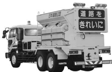
写真 6-26 湿式凍結防止剤散布車 MS-BWT型 範多機械(株) 平成 10年モデルチェンジ
