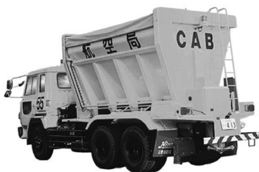
写真 6-20 超大型凍結防止剤散布車 MS-100BIT (F) 範多機械(株) 昭和62年
