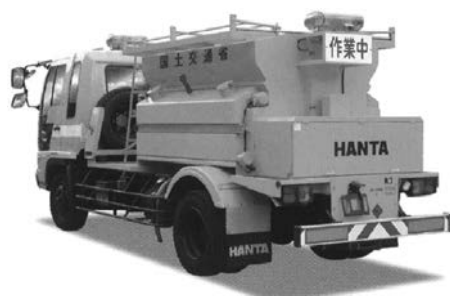
写真 6-25 湿式凍結防止剤散布車 MS-BIT (W)型 範多機械(株) 平成 13年
