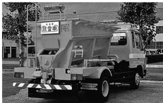
写真 6-22 乾式凍結防止剤散布車 2.5 m 級 ESD25 東洋運搬機(株) (注1) 昭和63年
