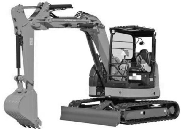
写真一 3 日立建機(株) ZX55UR-5B 超小旋回型ミニショベル
