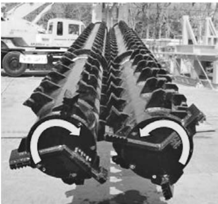
写真―3 掘削機の刃
