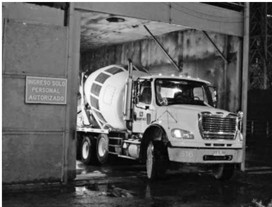
写真一 10 夜間 市街地で防音ピットへ入りコンクリ攪拌作業中のモバイルミキサ
