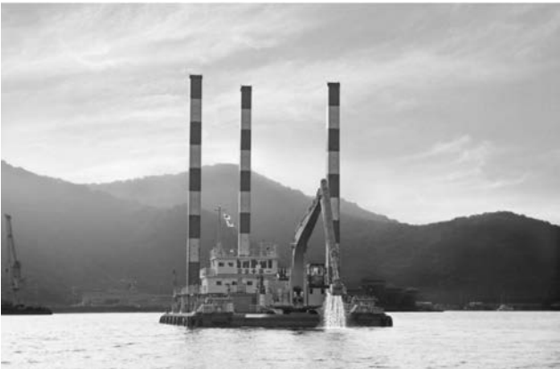
写真—6 五洋建設・大新土木 BHC-2401 多機能型バックホウ浚渫船
