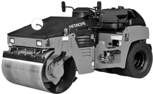
写真—3 日立建機 ZC50C-5 振動ローラ
