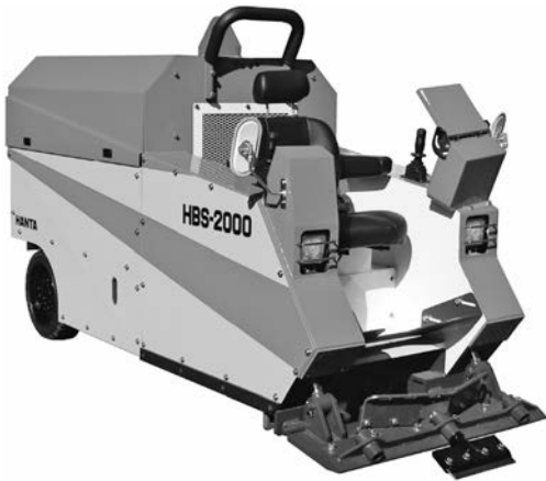
写真ー4 範多機械 HBS-2000 ライノス 搭乗式スクレーバ
