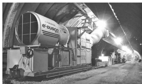
写真—2 吸引捕集方式への対応 (電気式)
