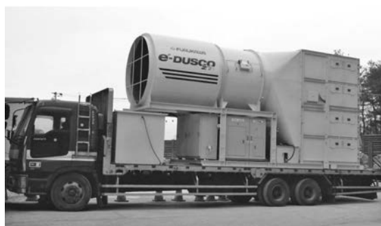
写真—1 希釈封じ込め方式への対応 (電気式)
