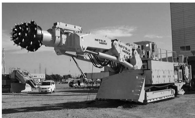
写真—2 国内最大級の自由断面トンネル掘削機
