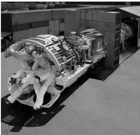
写真-3 海外メーカーが製作したディスクカッターによる掘削機<sup>2)</sup>
