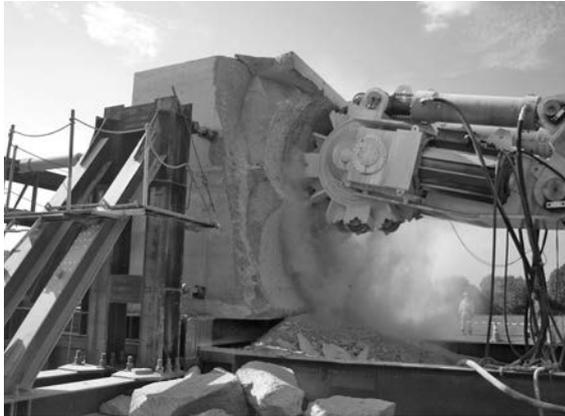
写真一五 掘削要素試験状況
