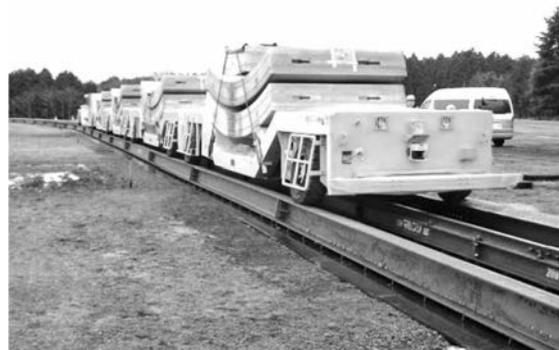
写真—13 タイヤ式自走台車
