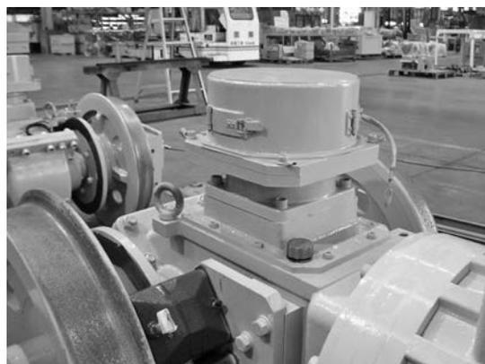
写真一 3 負作動電磁ブレーキ
