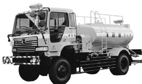
写真 6-64 溶液散布車 WSN-63T 範多機械(株) 平成 7 年
