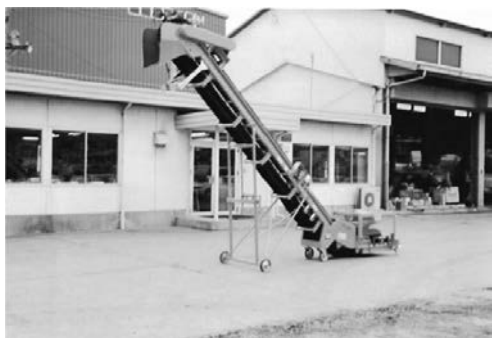
写真 6-70 凍結防止剤積込装置 NML-4 (株)日本除雪機製作所 平成 7 年
