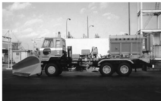
写真 6-77 フロントプラウとトラックグレーダを装着した凍結防止剤散布車 6 輪 3 軸駆動 (6 × 6)
