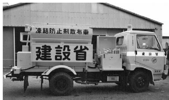
写真 6-73 標準タイプのトラック 4 輪 1 軸駆動 (4 × 2)
