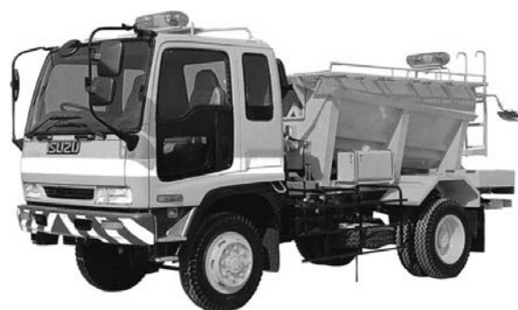
写真 6-74 高床式の車両 4 輪 2 軸駆動 (4 × 4)
