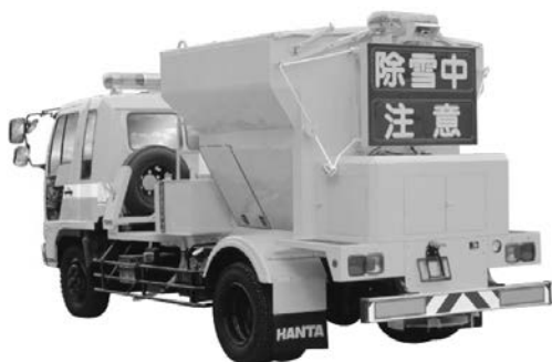
写真 6-75 低床式の車両 4 輪 2 軸駆動 (4 × 4)
