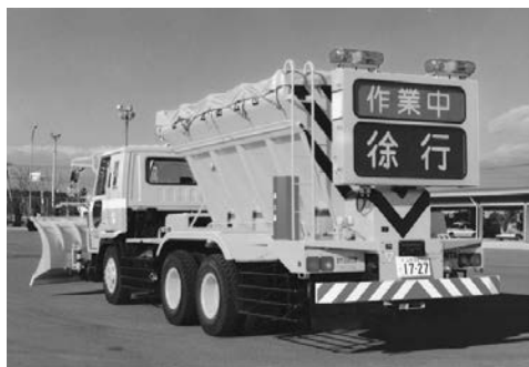
写真 6-76 フロントプラウを装着した凍結防止剤散布車 6 輪 2 軸駆動 (6 × 4)
