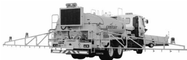
写真 6-65 溶液散布車 WS-80T 範多機械(株) 平成 18 年
