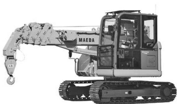
写真一六 前田製作所 CC985S-1 クローラクレーン
