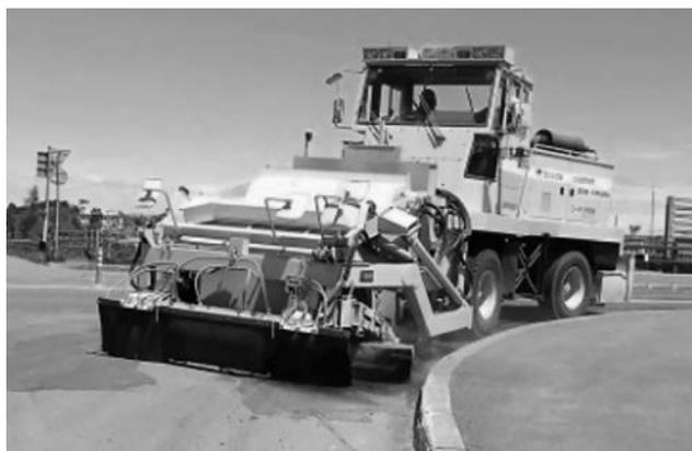
写真—4 路面清掃装置を装着したロータリ除雪車での路面清掃作業
