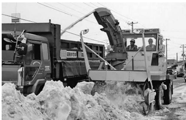
写真—5 ロータリ除雪車での運搬排雪作業
