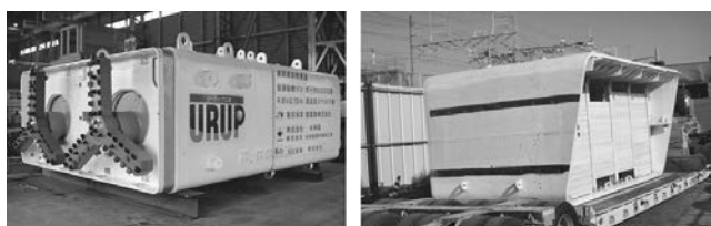
写真―1 シールド（左：密閉型、右：開放型前胴部）
