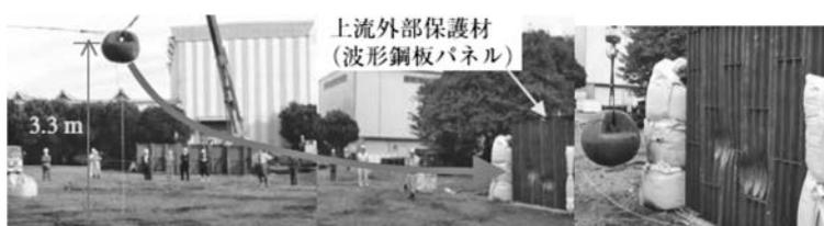
写真—3 波形鋼板パネルの实物大衝撃実験の状況
