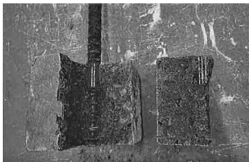
写真—6 付着強度試験後の破壊状況
