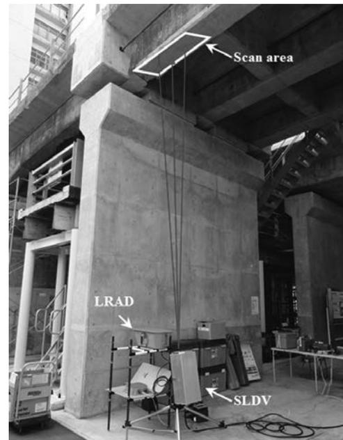
写真-1 音響探査法を用いた橋梁桁下面のはく離探査
