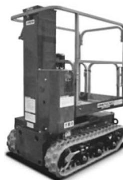
写真-4 アイチコーポレーション RM04CNS 自走式高所作業車
