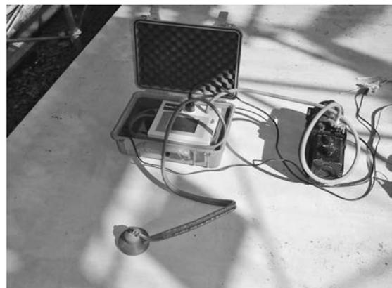
写真一11 透気試験器
