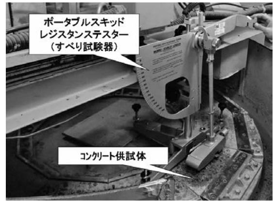
写真一 1 すべり試験の状況
