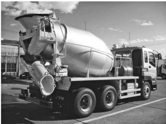
写真-1 電子制御コンクリートミキサー車
