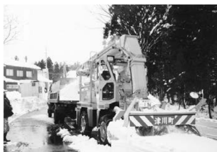
写真 7-50 小形除雪車 スライダー付 NR423 (株新潟鐵工所 (注3) 昭和 59 年
