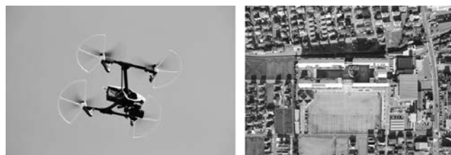
写真一 5 UAV 写真測量実習の様子
