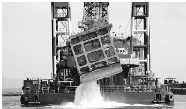
写真—1 3D グラブバケット装備
