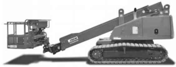
写真-1 アイチコーポレーション SR12CSM 自走式高所作業車
