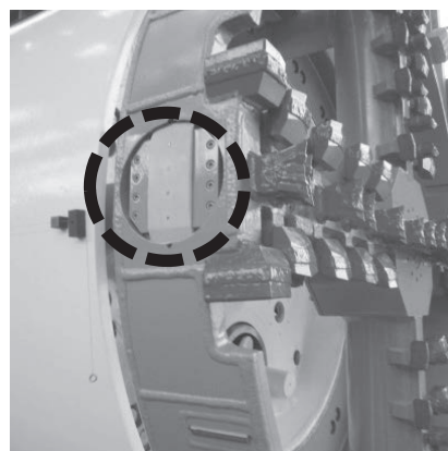
写真一1 センサー設置状況
