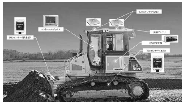
写真—3 本システムの構成
