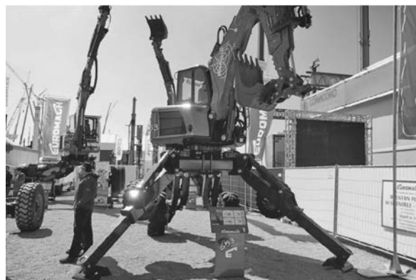
写真—9 4輪4脚式の油圧ショベル
