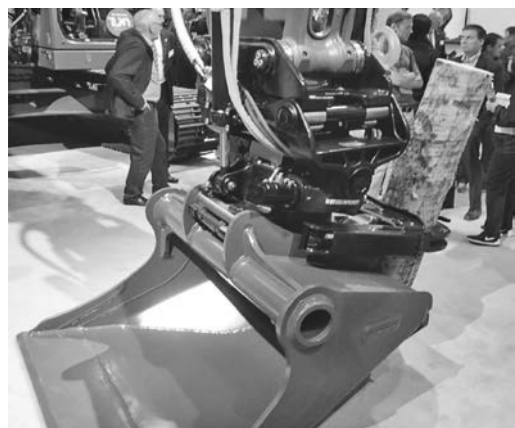
写真—13 油圧ショベルに多い複合アタッチメント (スウェーデン STEELWRIST など)
