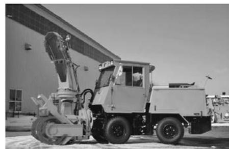
写真 7-69 小形除雪車 HTR83 (株)日本除雪機製作所 平成 15 年
