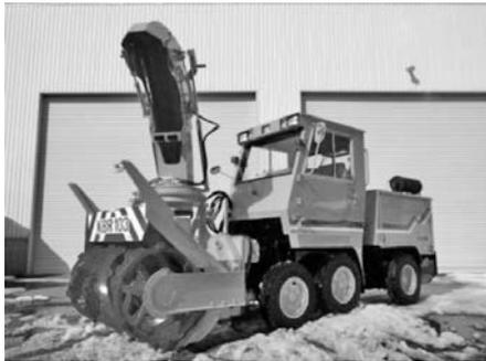
写真 7-77 小形除雪車 HTR103 (株)日本除雪機製作所 平成 20 年
