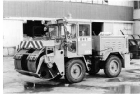
写真 7-80 ロータリ除雪車 MR120 のアタッチメント・パッチングローラ (道路用転圧機) (株)日本除雪機製作所 昭和 47 年
