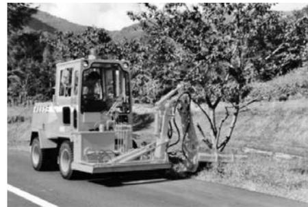
写真 7-81 小形除雪車 HTR80 のアタッチメント・全油圧式バロネス形草刈り装置 (株)日本除雪機製作所 昭和 56 年
