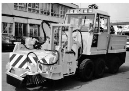
写真 7-85 小形除雪車 KBR100 のアタッチメント・路肩清掃装置
