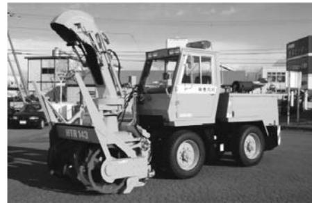
写真 7-68 小形除雪車 HTR143 (株)日本除雪機製作所 平成 15 年
