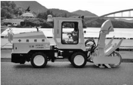
写真 7-79 小形除雪車 HTR53 (株)日本除雪機製作所 平成 21 年
