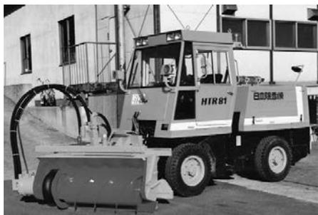
写真 7-84 小形除雪車 HTR81 のアタッチメント・路肩汚泥処理装置
