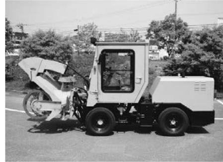
写真 7-67 小形除雪車 HTR51 (株)日本除雪機製作所 平成 15 年
