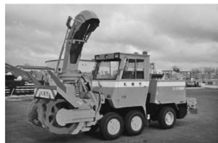
写真 7-70 小形除雪車 KBR102 (株)日本除雪機製作所 平成 15 年
