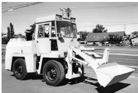
写真 7-83 小形除雪車 HTR140 のアタッチメント・バケット装置
