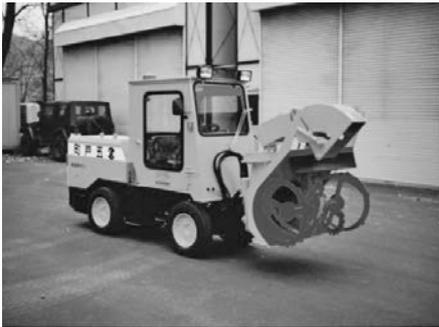
写真 7-64 小形除雪車 HTR50 (株)日本除雪機製作所 平成 11 年
