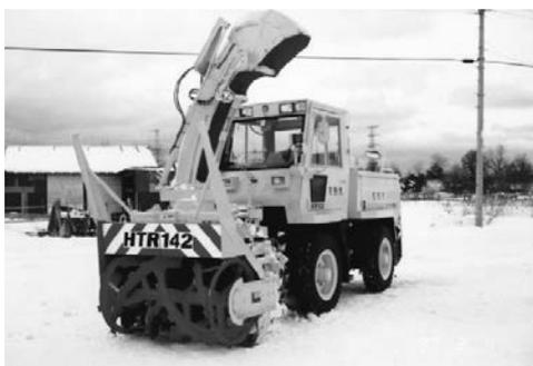
写真 7-60 小形除雪車 HTR142 (株)日本除雪機製作所 平成8年
