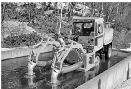
写真 7-86 小形除雪車 KTR141 のアタッチメント・排水ポンプ装置
