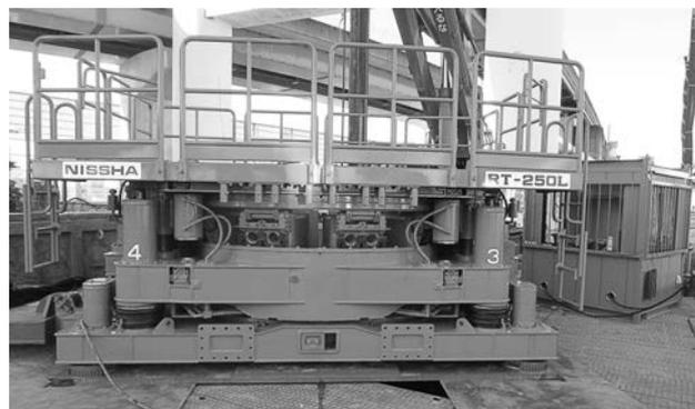
写真一七 日本車両 RT-250L 全回転チュービング装置
