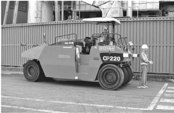
写真—6 ローラ自動停止システムの検証
