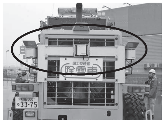
写真—4 車両検知部
