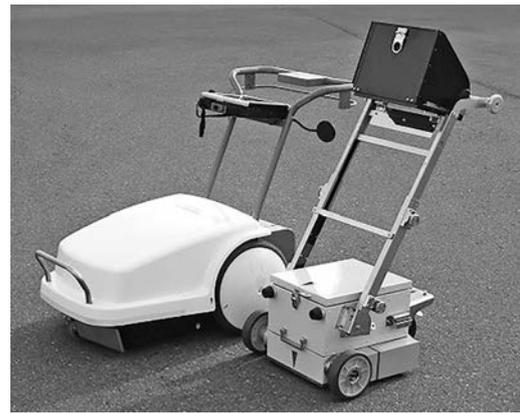
写真-1 埋設物探査用レーダの例
