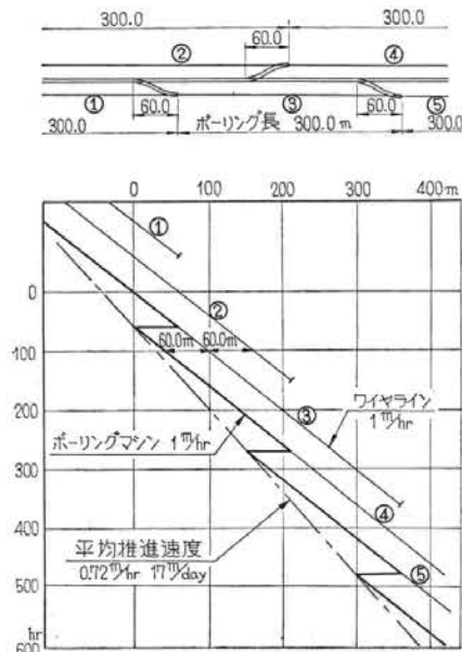
図-7 水平坑掘削工程表
