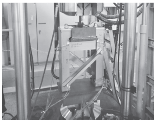
写真—8 吊支持材静的試験
