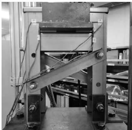
写真—9 吊支持材疲労試験
